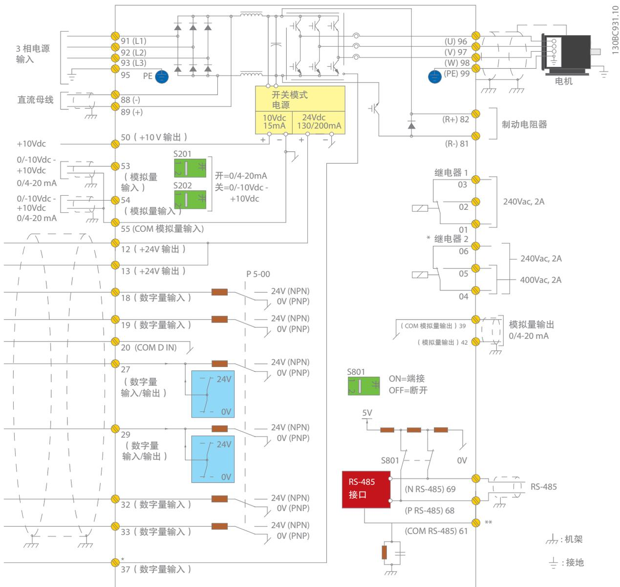
此图显示 VLT® AQUA Drive 的典型安装。电源连接到端子 91 (L1)、92 (L2) 和 93 (L3)，电动机连接到端子 96 (U)、97 (V) 和 98 (W)。
