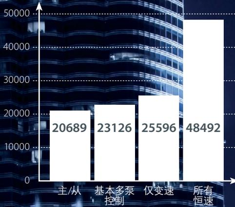
使用主/从模式，与传统的整个线路的泵/鼓风机开/关循环和阀门节流相比，能耗可降低一半以上。
