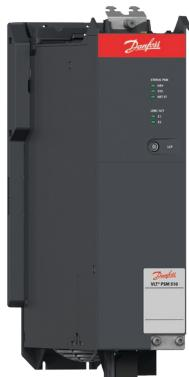
PSM 510 模块将产生 565-680 直流回路电压，可提供 3 种功率规格，分别为 10、20 或 30 kW 以及 200% 过载能力。要实现最高 60 kW 的额定输出，可并联安装两个 PSM 510 设备。
