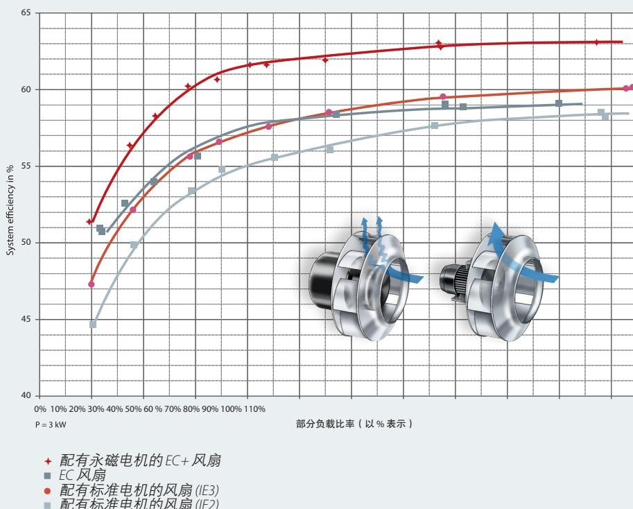
空气处理与制冷研究所的测量结果证实，只有通过将最佳的组件进行组合才能达到最高的系统效率。例如：丹佛斯 EC+ 系统通过将变频器、电机与风扇叶轮进行优化组合，使风扇损耗降低 11% 之多。不理想的叶轮几何形状会对 EC 风扇出色的电机效率产生不利影响，导致系统效率下降大约 3% 至 5%。
