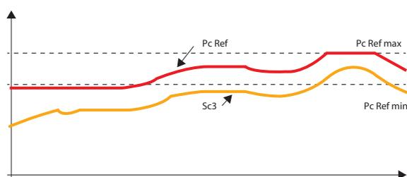
Controllo del setpoint della temperatura di condensazione fluttuante con il VLT® Refrigeration Drive FC 103.
