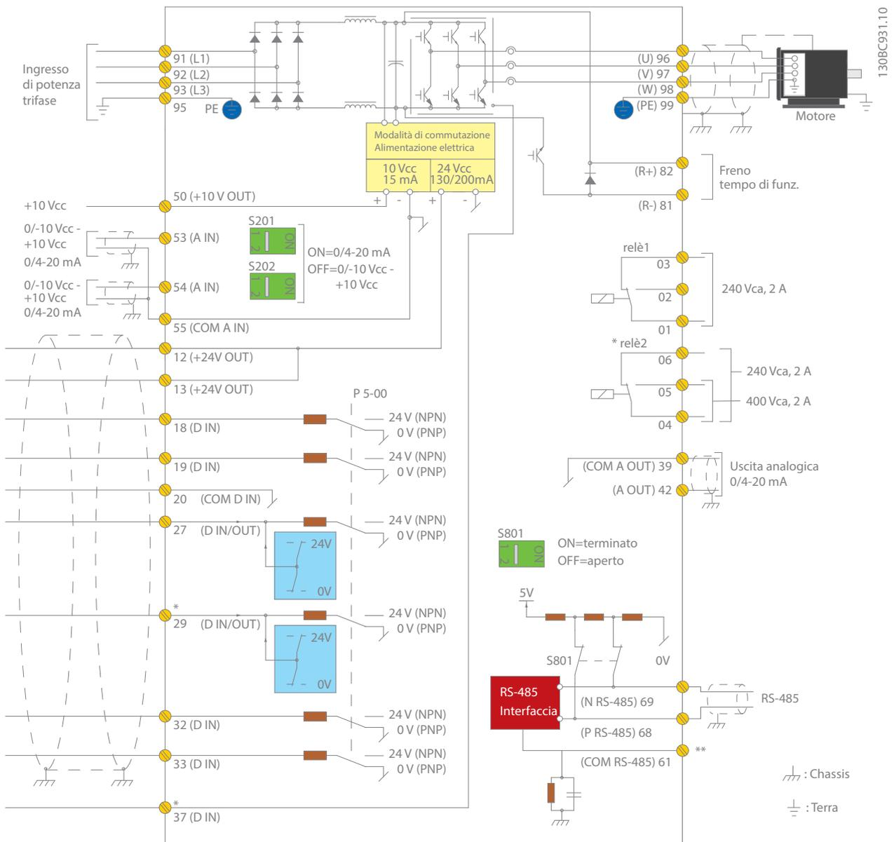
Questo schema mostra una tipica installazione del VLT® Refrigeration Drive. L'alimentazione è collegata ai morsetti 91 (L1), 92 (L2) e 93 (L3) e il motore è collegato a 96 (U), 97 (V) e 98 (W).
