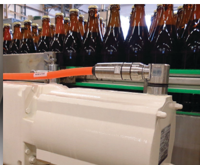
CleanConnect™ Edelstahl-Stecker sorgen für einfache, sichere Anschlüsse auch während Austauscharbeiten.
