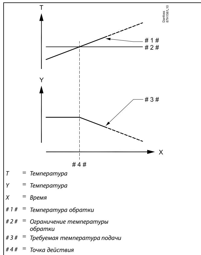
Пример: ограничение минимальной температуры обратки; температура обратки падает ниже установленного предела
