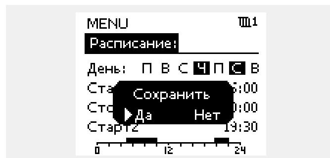
Каждый контур обладает отдельным графиком. Для выбора другого контура, перейдите на начальный экран, и, поворачивая диск, выберите необходимый контур.
