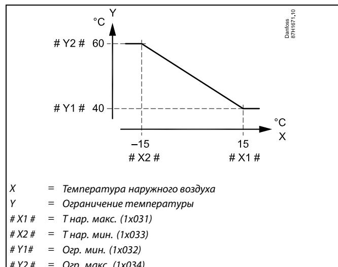
Рассчитанный предел приведен в скобках () на дисплее контроля. См. раздел «Контроль температур и компонентов системы».
