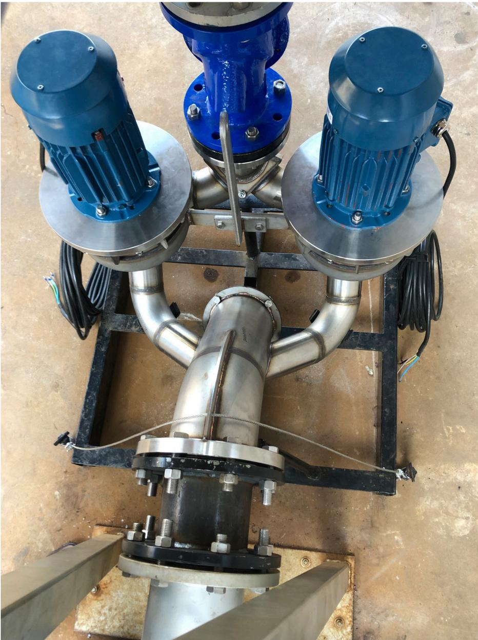
O ponto de partida para obter este destaque consistiu no desenvolvimento de sistemas completos de bombeamento em linha, que incluem os mecanismos de acionamento e controle para gestão do funcionamento adequado das bombas de esgoto.
