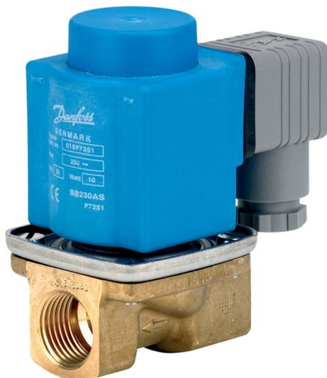
EV221BW 10, 14, 20 e 22 è un'elettrovalvola servocomandata diretta a 2/2 vie. Questo tipo di valvola è progettato con guarnizione EPDM, in ottone ecologico resistente alla dezincatura senza piombo per applicazioni con acqua potabile.
