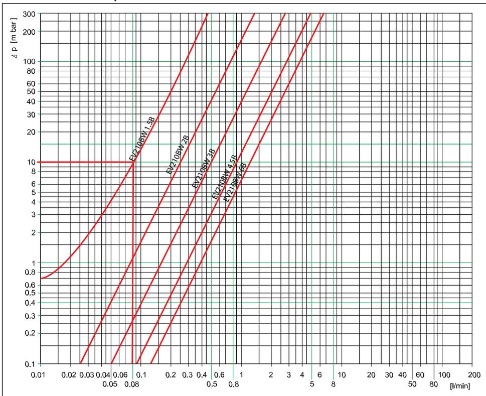
**Exemple, eau sous haute pression :** Capacité pour une EV210BW 2.5B avec un différentiel de pression de 1,5 bar. Environ 0,1 m<sup>3</sup>/h
