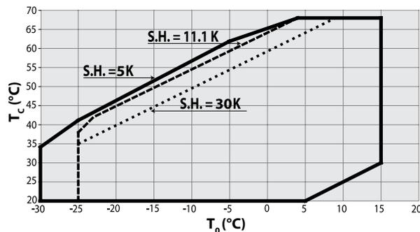
⚠ Este compresor solo debe utilizarse para el cometido para el que ha sido diseñado y dentro de su campo de aplicación (consulte «límites de funcionamiento»). Consulte las directrices de aplicación y las especificaciones técnicas disponibles en [cc.danfoss.com](http://cc.danfoss.com).
