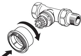
Postavite adapter RTD na ventil, kot prikazuje slika.
