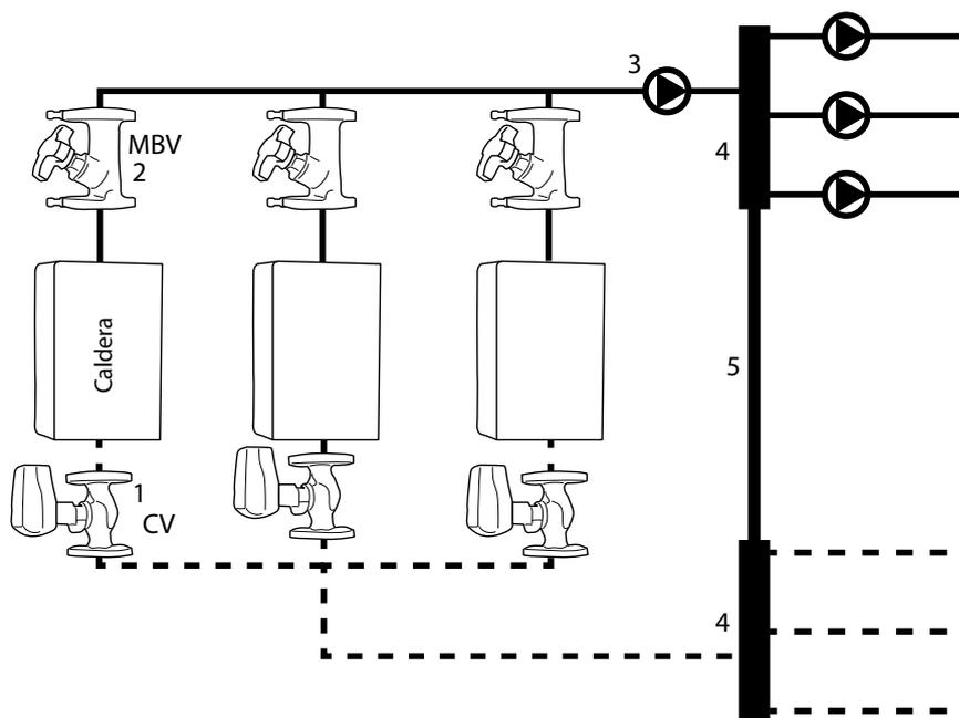
Esta es la disposición más común de la planta de calderas de caudal primario constante (en cascada). Los sistemas primario y secundario son hidráulicamente independientes. Los colectores están conectados con un bypass que permite la circulación de agua entre ellos.
