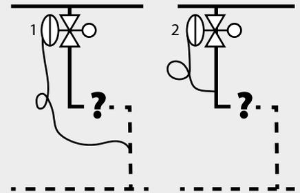
1. Válvula de equilibrado automático combinada como controlador de  $\Delta p$  (PICV 1)
