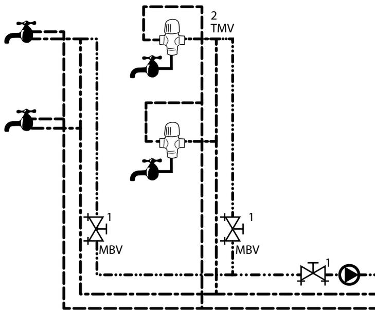
En esta aplicación garantizamos un caudal constante\* en la tubería de circulación de agua caliente sanitaria, independientemente del uso y la demanda temporales de agua caliente. TMV (opcional) garantiza la máxima temperatura de consumo para evitar escaldamientos.
