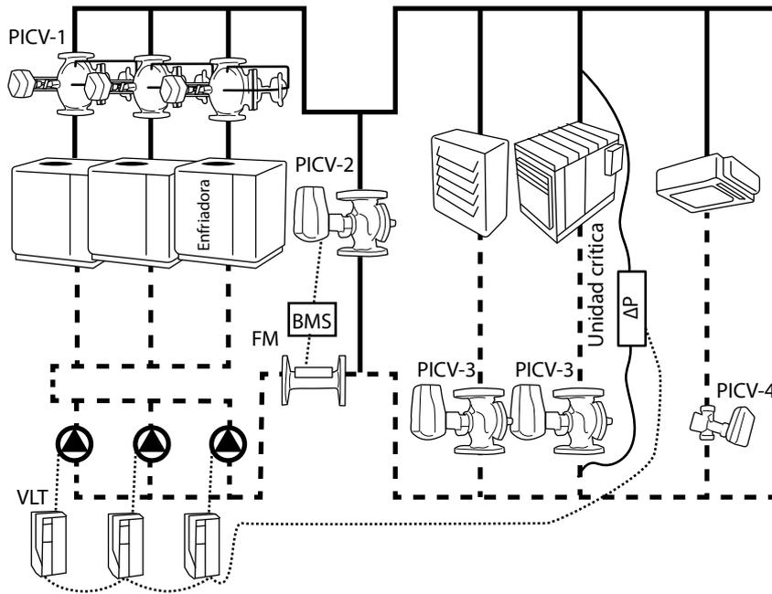
En un sistema de caudal variable\*, se considera el sistema más eficiente para el funcionamiento térmico de un edificio. Las enfriadoras pueden tener múltiples compresores de velocidad variable.
