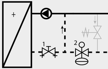
1. Válvula de control independiente de la presión (PICV)
