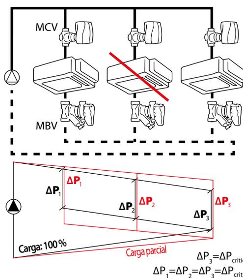
Fig. 11.2 Carga parcial - sistema de retorno inverso
