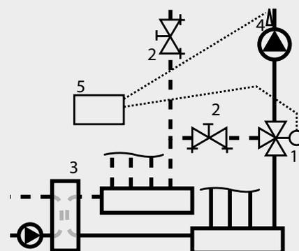
1. Válvula de control de 3 vías (CV)
