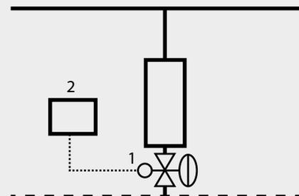
1. Válvula de control independiente de la presión (PICV)
