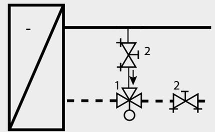
1. Válvula de control de 3 vías (CV)
