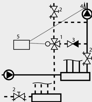
1. Válvula de control de 3 vías (CV)
