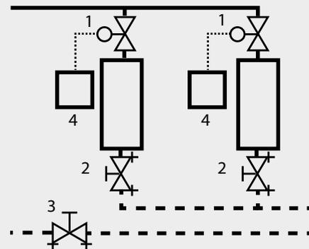
1. Válvula de control de 2 vías (CV)
