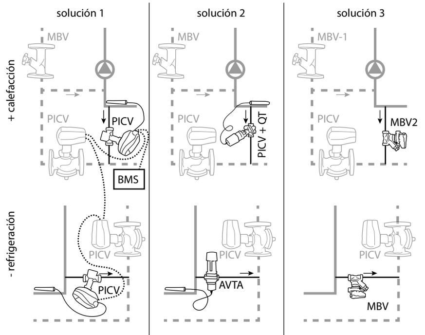
En las instalaciones de caudal variable\*, es posible que el agua del sistema tenga una velocidad de caudal tan baja que se caliente (enfriamiento) o se enfríe (calefacción), por lo que la UTA tardará un tiempo en iniciar la refrigeración o la calefacción. En estos casos, se recomienda instalar un bypass en la unidad más alejada para mantener la temperatura del sistema. Se pueden utilizar diferentes tipos\* de control de bypass. Las opciones son:
