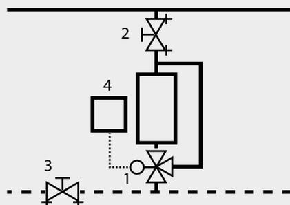
1. Válvula de control de 3 vías (CV)
