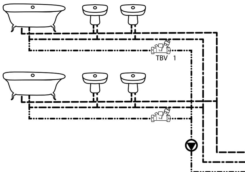
En esta aplicación, garantizamos un caudal variable\* en la tubería de circulación de ACS\* y una temperatura de consumo constante en cualquier grifo, independientemente de la distancia entre el depósito de almacenamiento y el uso temporal de agua caliente. Gracias a esto, reducimos la cantidad de agua de circulación durante todos los periodos. La desinfección térmica\* es posible con equipos adicionales.
