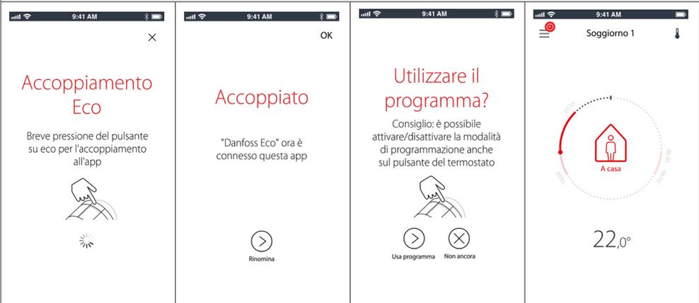
Seguire le istruzioni della Danfoss Eco™ App per accoppiare Danfoss Eco™. La portata del Bluetooth è di 10m (può variare in base alla struttura dell'edificio ed all'ambiente circostante).
