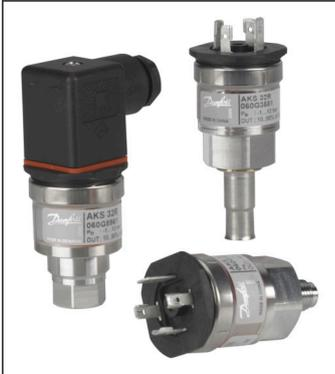
El AKS 32R es un transmisor de presión ratiométrica que transforma la presión medida en una señal de salida lineal. La señal de salida es relativa a la tensión de alimentación, lo que significa que la salida de presión mínima será el 10 % de la tensión de alimentación real y el máximo la salida de presión será del 90 % de la tensión de alimentación real.
