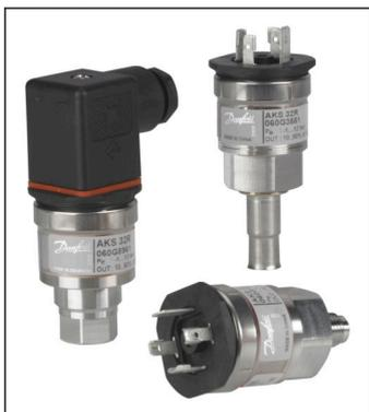
AKS 32R представляет собой ратиометрический датчик давления, который преобразует измеренное давление в линейный выходной сигнал. Выходной сигнал зависит от напряжения питания таким образом, что минимальное выходное значение давления составляет 10 % от фактического напряжения питания, а максимальное выходное значение давления составляет 90 % от фактического напряжения питания.
