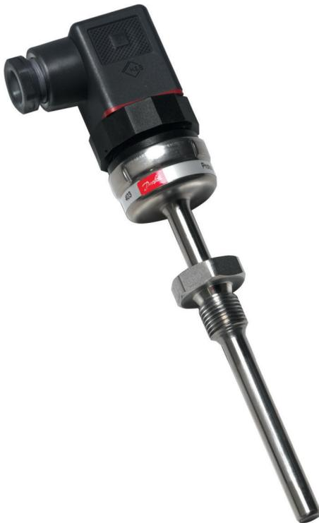
En el MBT 5560 hemos combinado la tecnología de nuestros sensores de temperatura estándar y las conexiones eléctricas de nuestros transmisores de presión MBS con una nueva electrónica desarrollada, lo que ha dado como resultado un sensor de temperatura compacto con un transmisor integrado.
