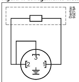
**Sensore di temperatura, tipo MBT 3250**
