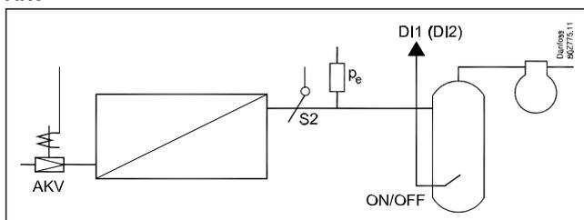
Un contacteur de niveau dans le réservoir enregistre lorsque le niveau de liquide dépasse le niveau max. Lorsque cela se produit, le régulateur passe en détente sèche, puis revient en régulation liquide lorsque le niveau de liquide a baissé. La fonction est définie dans le réglage o02, o37 ou o84.
