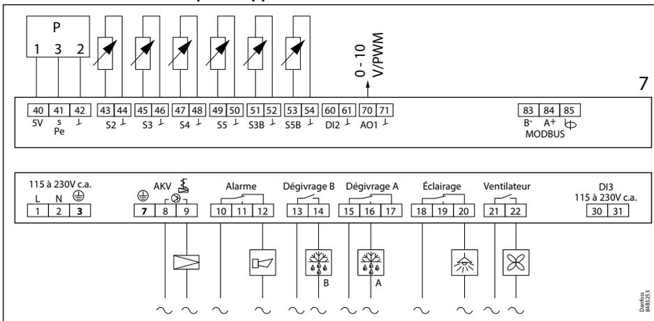
**Chiffre 43: Raccordements pour l'application 8**
