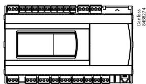
Pour les régulateurs avec afficheur intégré, un seul afficheur externe peut être raccordé.
