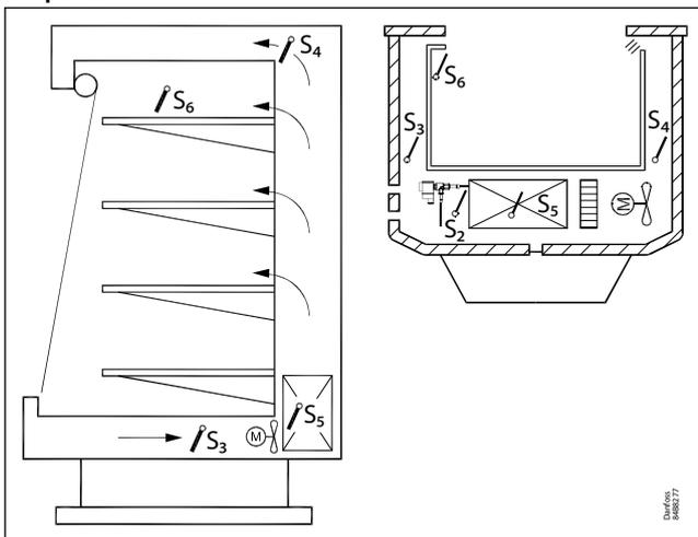
**Chiffre 32: Armoire dos à dos avec un évaporateur**
