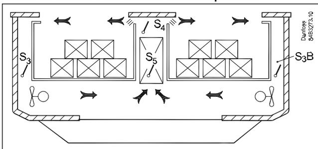
**Chiffre 33: Armoire dos à dos avec deux évaporateurs et une soupape AKV**
