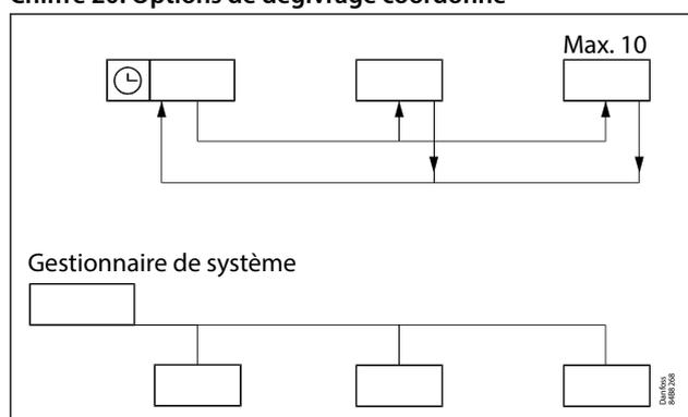
Soit avec des connexions câblées entre les régulateurs, soit via la transmission de données :
