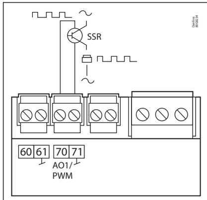
0/10 V modulé en largeur d'impulsions (PWM)
