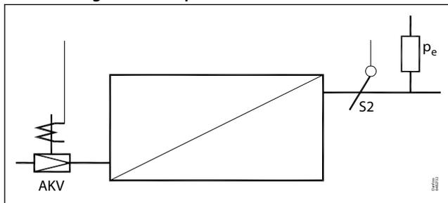
La surchauffe est mesurée par une sonde de pression  $P_e$  et une sonde de température  $S_2$ . En utilisant une sonde de pression et une sonde de température, une mesure correcte de la surchauffe est obtenue dans toutes les conditions, ce qui garantit une régulation très robuste et précise. Le signal d'un transmetteur de pression peut être partagé par un max. de 10 régulateurs, mais uniquement s'il n'y a pas de différence de pression significative entre les évaporateurs en question.
