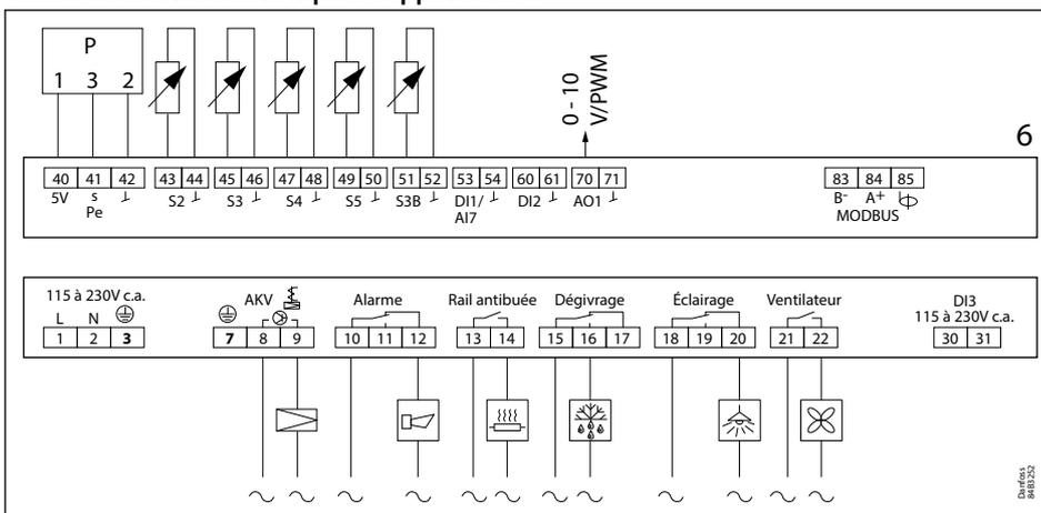
**Chiffre 42: Raccordements pour l'application 7**
