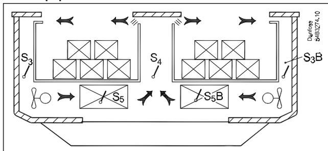
**Chiffre 34: Configuration de chambre froide avec fonction de régulation de la température de la porte et de l'éclairage**
