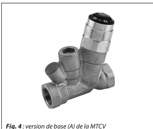
La MTCV est une vanne thermostatique automotrice proportionnelle. Une cartouche thermostatique (fig. 6 élém. 4) est placée dans le cône de la vanne (fig. 6, élém. 3) afin de réagir aux variations de la température.
