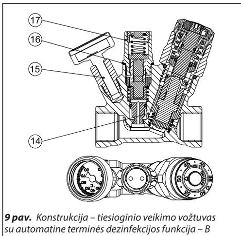
**9 pav.** Konstrukcija – tiesioginio veikimo vožtuvas su automatine terminės dezinfekcijos funkcija – B
