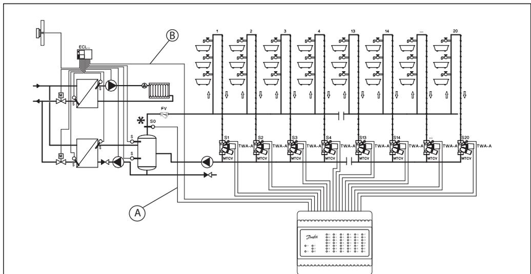
11 pav. Dezinfekcijos ir temperatūros registravimo sistemos schema
