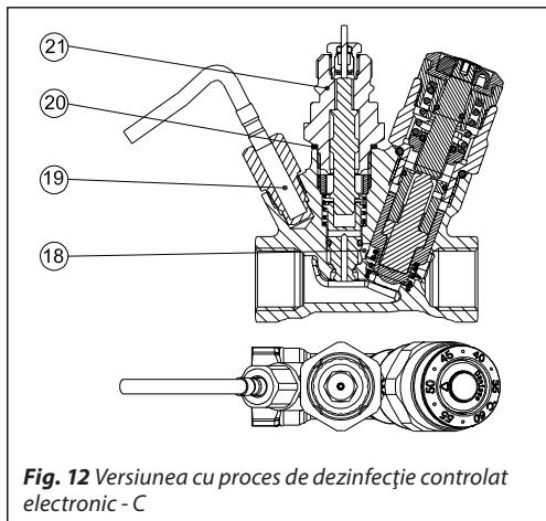
**Fig. 12** Versiunea cu proces de dezinfecție controlat electronic - C
