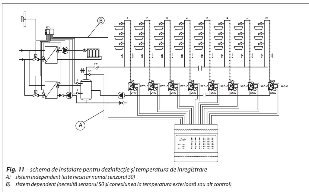
**Fig. 11** – schema de instalare pentru dezinfecție și temperatura de înregistrare
