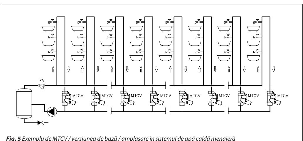
**Fig. 5 Exemplu de MTCV / versiunea de bază / amplasare în sistemul de apă caldă menajeră**
