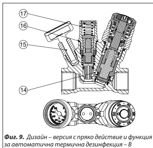
**Фиг. 9.** Дизайн – версия с пряко действие и функция за автоматична термична дезинфекција – В
