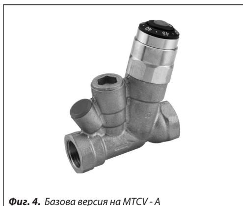
MTCV е термостатичен пропорционален вентил с пряко действие. Термоелементът, (фиг. 6, елем. 4) разположен в конуса на вентила (фиг. 6, елем. 3), реагира на промени в температурата.
