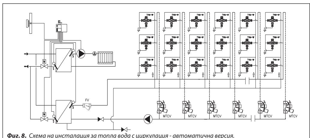
**Фиг. 8.** Схема на инсталация за топла вода с циркулация - автоматична версия.
