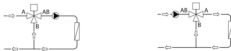
Фиг. 4: Отклоняващ вентил, използван в отклоняващо приложение
