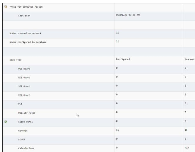
Cette opération garantit la synchronisation de la base de données de l'AK-SM avec tous les régulateurs préconfigurés présents sur le réseau. Tout échec de chargement est signalé sur cet écran. Sinon, une date et une heure apparaissent.
