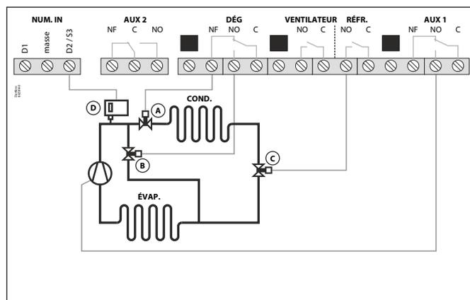
En option, un pressostat haute pression (D) peut être ajouté pour réguler l'électrovanne (entrée numérique D2, **I20=9**) pendant le processus de dégivrage à l'aide de gaz chauds. Si la pression diminue, l'électrovanne s'ouvre pour laisser entrer le fluide dans la cuve ; lors de la nouvelle augmentation de la pression, l'électrovanne se ferme.
