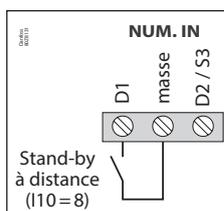
Cela permet d'activer le mode Stand-by à l'aide d'un commutateur connecté à l'une des entrées numériques. Cette entrée numérique doit être réglée sur l'activation à distance Veille (**I10=8** ou **I20=12**).
