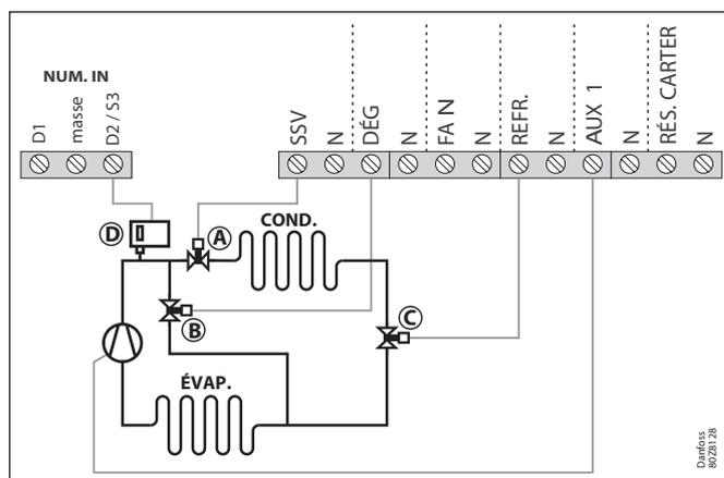
Pendant le procédé, l'électrovanne de liquide (C) et la vanne d'admission du condenseur se ferment et la vanne d'admission de l'évaporateur s'ouvre, forçant les gaz chauds à passer à travers cette dernière et faisant fondre le givre.
