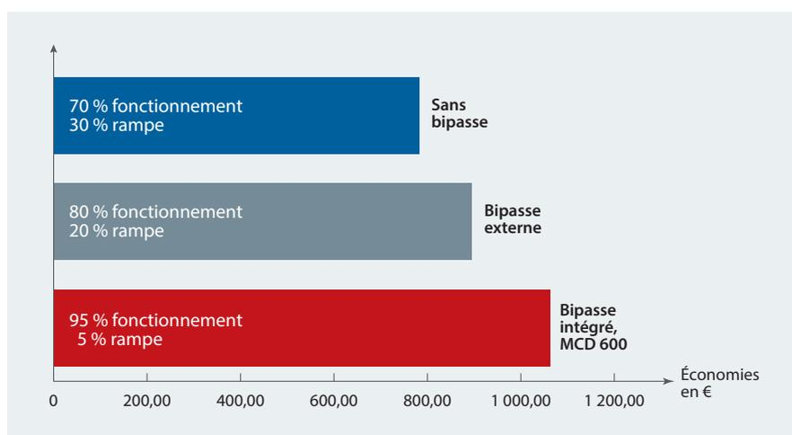
Économies réalisées en utilisant un bipasse, montrant l'effet bénéfique de l'augmentation du temps de fonctionnement et de la réduction du temps de rampe.
