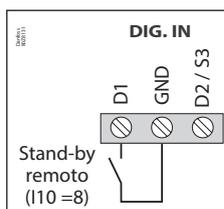
Esto permite activar el modo Stand-By utilizando un interruptor conectado a una de las entradas digitales. Dicha entrada digital debe estar ajustada a activación remota en Stand-by (**I10=8** o **I20=12**).
