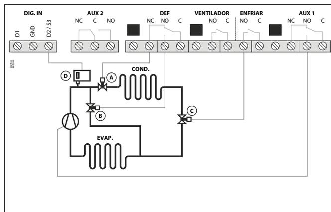
Opcionalmente, se puede añadir un interruptor de alta presión (D) para controlar la válvula solenoide (entrada digital D2, **I20=9**) durante el proceso de desescarche utilizando gas caliente. Si la presión disminuye, la válvula solenoide se abre para permitir la entrada de líquido en el depósito; cuando la presión vuelve a aumentar, la válvula solenoide se cierra.
