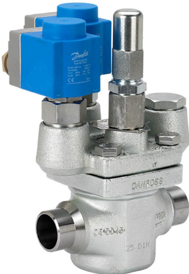
L'électrovanne ICSH à double position appartient à la gamme ICV et comporte un boîtier ICV, un insert ICS ainsi qu'un couvercle supérieur ICSH avec deux électrovannes pilotes EVM normalement fermées installées sur le couvercle supérieur.
