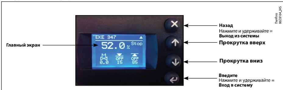
Интерфейс пользователя на панели управления состоит из многострочного дисплея и четырех кнопок: кнопка ввода, кнопка прокрутки вверх, кнопка прокрутки вниз и кнопка «Назад».
