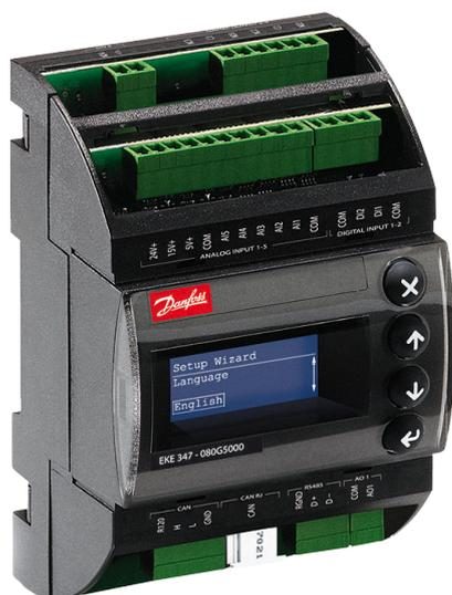
Контроллер EKE 347 предназначен для регулирования уровня жидкости в следующих устройствах:
