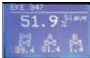
По умолчанию на дисплее ведомого контроллера ЕКЕ отображается фактический уровень жидкости (как на ведущем устройстве), символ нескольких клапанов, фактическая общая степень открытия и степень открытия соответствующих отдельных клапанов (см. ниже).
