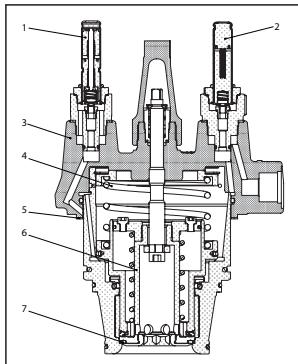
表 64: ICLX 50 / ICLX 65 两步开启电磁阀模块
