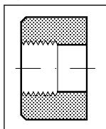
表 71: FPT: 内螺纹管螺纹 (ANSI/ASME B 1.20.1)
