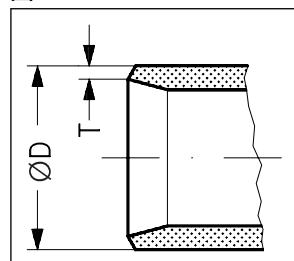
表 66: D: 对接焊 DIN (EN 10220)
