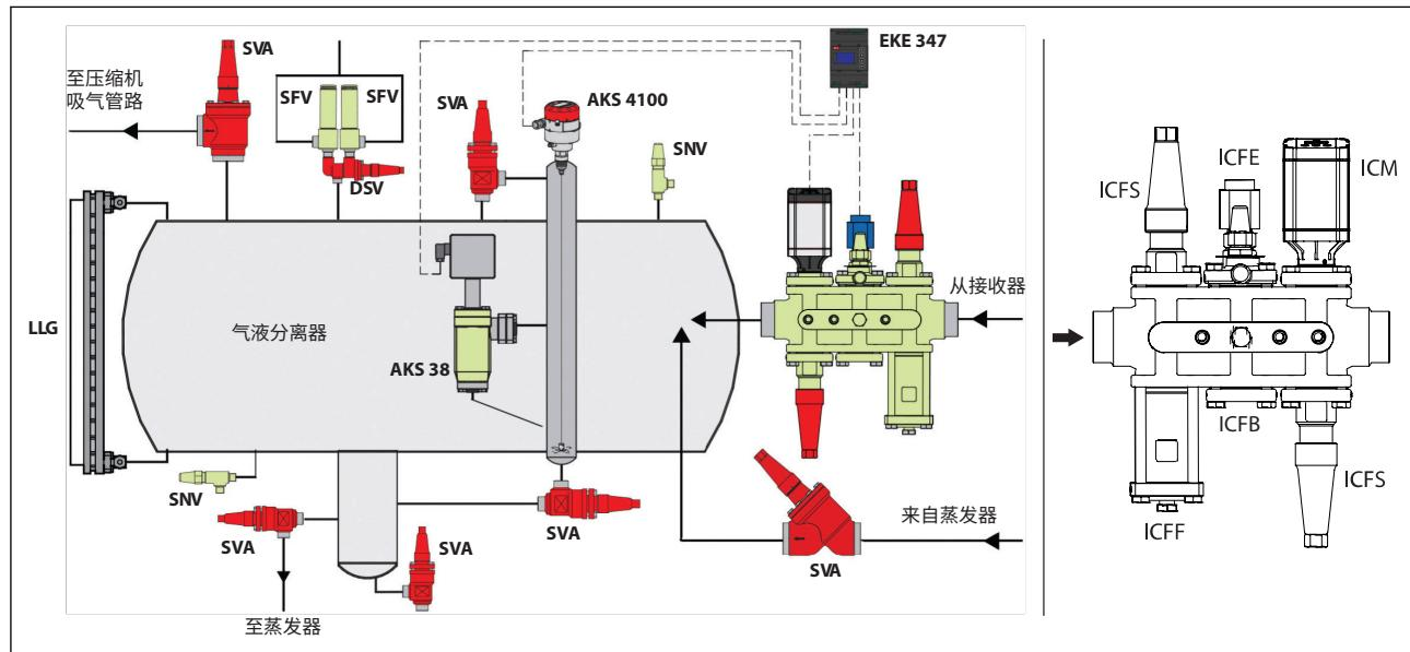
带电子喷射阀的压缩机液体喷射装置必须采用阀组。要求在控制阀前端安装一个电磁阀。
