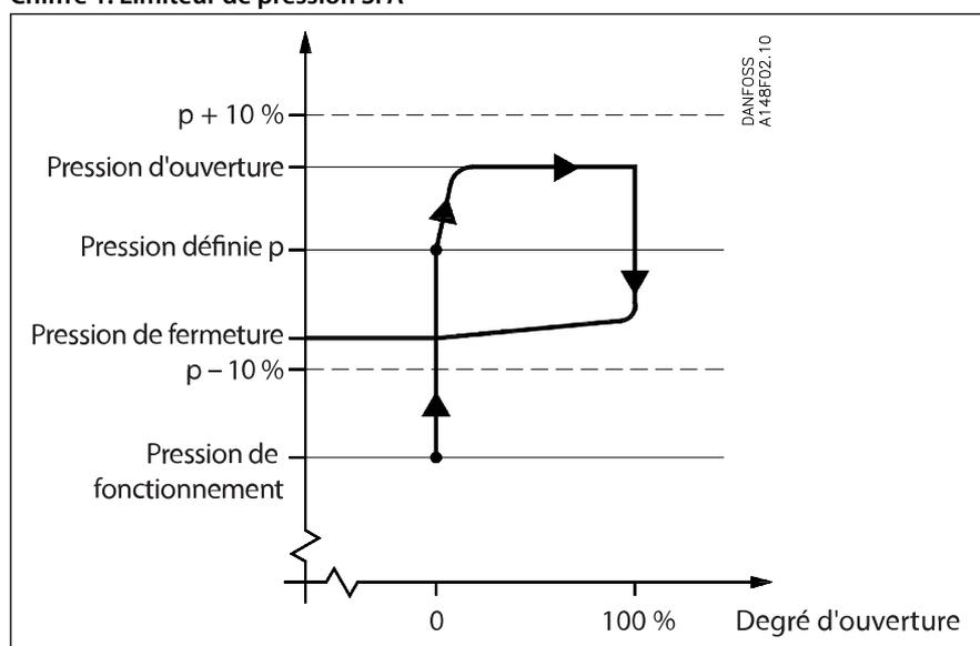
La SFA est conçue comme une soupape de sécurité à chargement direct qui est particulièrement recommandée pour les applications de réfrigération. En cas d'augmentation de la pression au-delà de la pression définie, la soupape de sécurité commencera par s'ouvrir légèrement pour limiter la sortie de réfrigérant.
