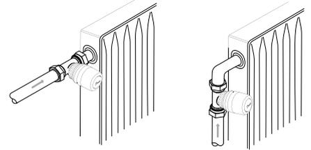
**带远程传感器的散热器恒温阀**
