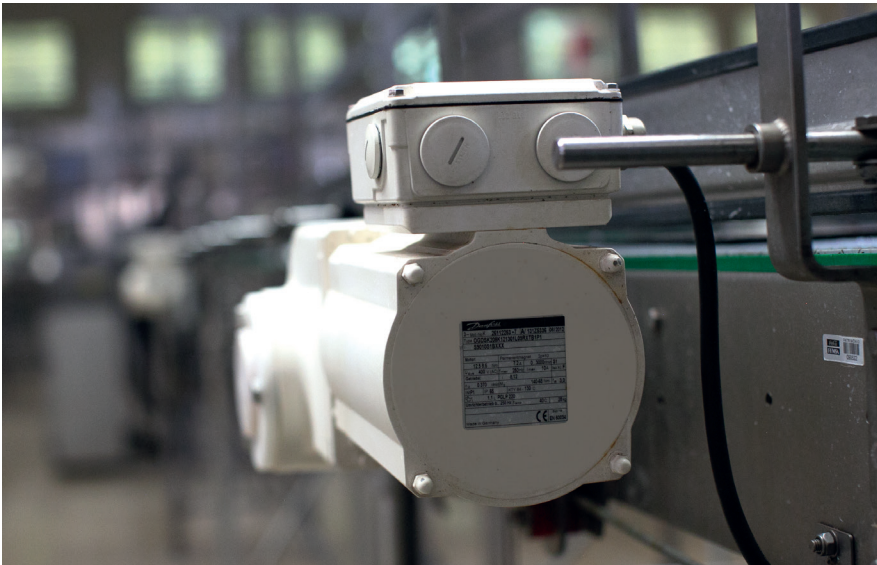
Los convertidores VLT controlan la velocidad de los transportadores de la línea de embotellado, tanto de forma descentralizada...
