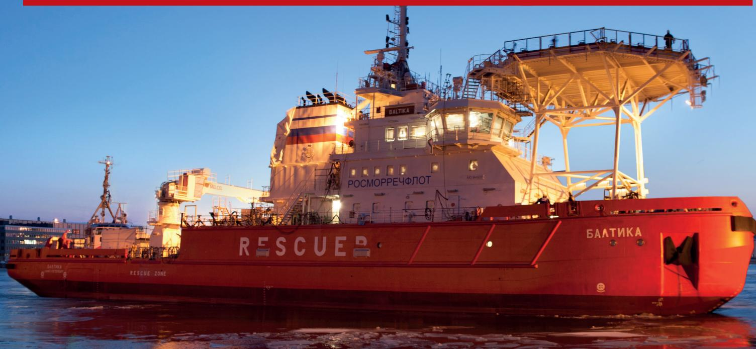
波罗的海号是全球第一艘侧向破冰船，属于多用途紧急救援船。主推全回转推进器 - 由芬兰劳马 Steerprop 公司提供 - 由 VACON® 变频器控制。与传统的液压转向系统相比，新型变频器控制更准确、可靠，且运行噪音小。其他优点包括占用空间小且易于安装。
