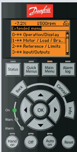
Střídavé pohony VLT® a VACON® jsou vybaveny uživatelsky přívětivým ovládacím panelem LCP, jenž lze připojit za provozu, který umožňuje snadné nastavení měniče a konfiguraci parametrů.
