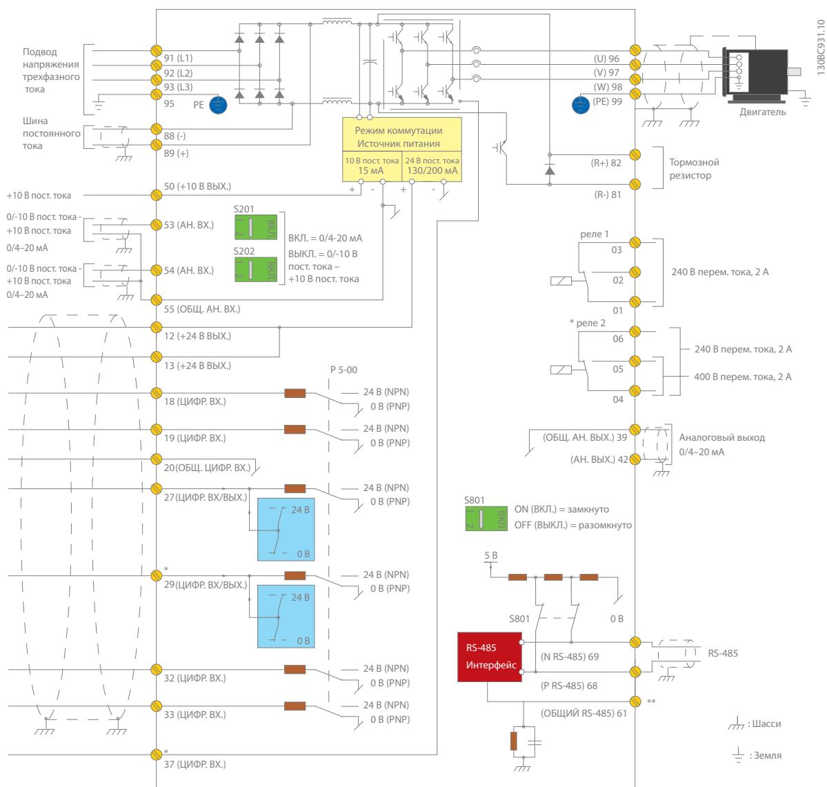
На схеме показаны все электрические клеммы без дополнительных устройств.
