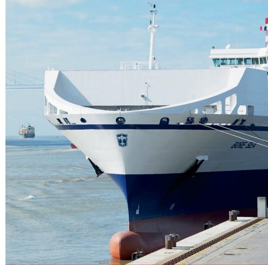
*“Wir waren über die höhere Energieeffizienz, die sich durch die vielseitigen technischen Lösungen für die M/V Bore Sea erzielen ließ, hoch erfreut. Entsprechende Analysen konnten belegen, dass der Wellengenerator von WE Tech Solutions mit VACON® Umrichtern eine Reduzierung der Treibstoffkosten in Höhe von 10 % ermöglichte. Bei Treibstoffkosten in Höhe von 500 € pro Tonne sind das erhebliche Einsparungen pro Jahr. Außerdem sinken dadurch die CO<sub>2</sub>-Emissionen um 2000 Tonnen.”*
