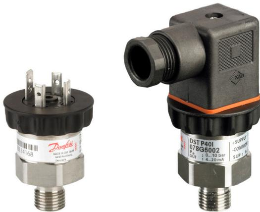
Le transmetteur de pression DST P40I (Danfoss Sensor Technology) a été conçu pour une utilisation dans des environnements industriels corrosifs tels que les systèmes de dessalement, le refroidissement de l'eau de mer, les eaux usées, etc.
