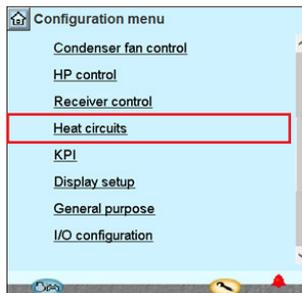
Wenn im Menü „Anlagentyp auswählen“ die Wärmerückgewinnung ausgewählt ist, erscheint das Menü „Heizkreise“.
