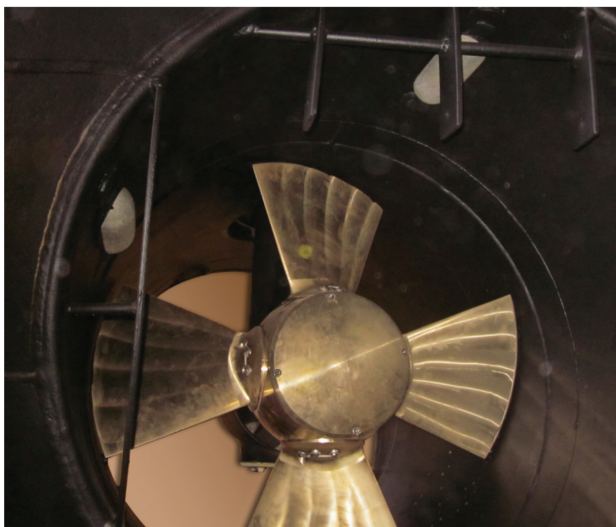
Tunnel thruster aboard the MV Fugløyhav
