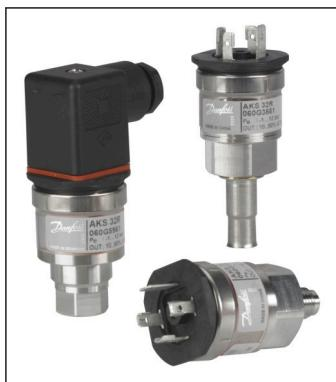
AKS 32R 是一款比率压力变送器, 可将测量压力转换为线性输出信号。输出信号与电源电压有关, 也就是说压力输出为实际电源电压的 10%, 最大压力输出为实际电源电压的 90%。
