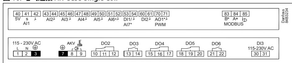
AK-CC55 Single Coil 经过优化，用于控制一个膨胀阀及灯、导轨热量和报警继电器的不同组合。
