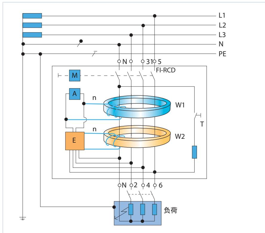
B类 RCD 有两条独立监测电路：一个电路用于监测纯直流，另一个电路用于监测交流组件的故障电流。
