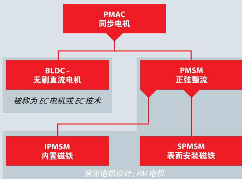
**注意：**讨论 EC 电机时，经常比较单相电机和三相电机的特性。示例：单相 EC 电机通常配有力率因数修正 (PFC)，以便让功率因数接近 1，而三相电机则无需 PFC。因此，用户应确定遵循的技术规范。
