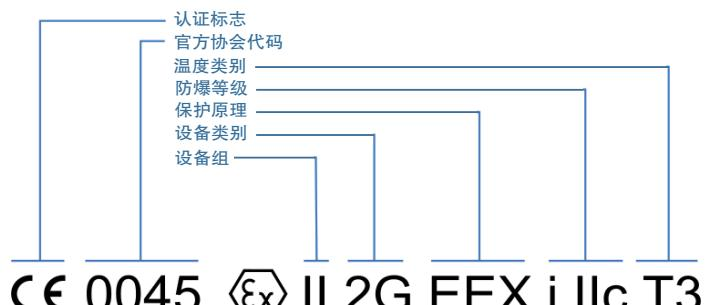
根据 ATEX 产品指令(94/9/EC) 对在潜在爆炸性环境中运行的设备贴上标签。
