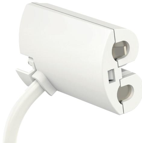
El módulo de alimentación de 24 V Danfoss Ally™ es un accesorio que conecta el cabezal termostático electrónico a un sistema de alimentación existente en la vivienda y permite que el dispositivo funcione sin baterías. La salida de potencia debe ser una fuente de alimentación de 24 V de una fuente segura con un nivel de aislamiento de clase II (suministro eléctrico con un nivel de aislamiento doble o reforzado integrado entre la tensión de alimentación y la tensión segura).
