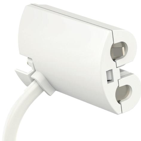
Le module d'alimentation 24 V Danfoss Ally™ permet d'alimenter la tête électronique par un réseau existant dans l'immeuble et de la faire fonctionner sans pile. La sortie d'alimentation doit être une alimentation 24 V d'une source sûre avec un niveau d'isolation de classe II (alimentation avec niveau d'isolation intégré double ou renforcé entre la tension d'alimentation et la tension de sécurité).
