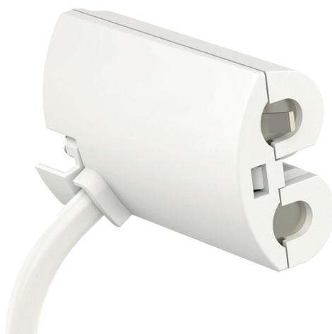
Il modulo di alimentazione Danfoss Ally™ 24 V è un accessorio che collega la testa termostatica per radiatori a un sistema di alimentazione esistente nell'edificio e consente al dispositivo di funzionare senza batterie. Alimentazione 24 V proveniente da una fonte sicura con isolamento di classe II (alimentazione con livello di isolamento integrato doppio o rinforzato tra la tensione di alimentazione e la tensione di sicurezza).
