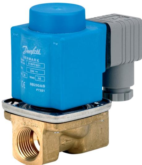
EV221BW 10, 14, 20 und 22 sind direkt servogesteuerte 2/2-Wege-Magnetventile. Dieser Ventiltyp besteht aus bleifreiem entzinkungsbeständigem ECO-Messing mit einer EPDM-Dichtung für Trinkwasseranwendungen.
