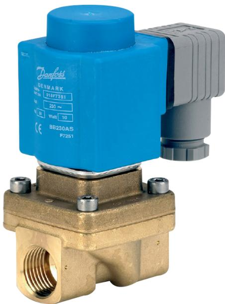
Les électrovannes EV250BW 10, 12, 18 et 22 à ouverture assistée peuvent fonctionner avec une pression différentielle de 0-10 bar. Ce programme de vanne 2/2 voies est particulièrement utilisé dans les applications à faible différentiel de pression mais requérant des débits modérés.
