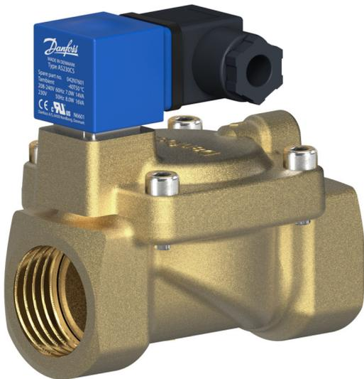
L'EV220W è una gamma di elettrovalvole compatte a servoazionamento indiretto a 2/2 vie con attacchi da 3/8" a 2", progettata appositamente per l'uso in spazi in cui esistono problemi di ingombro. Questa gamma è stata progettata per l'uso in vari mercati, come quello industriale e HVAC, che richiedono una valvola facile e affidabile, facile da installare e utilizzare.
