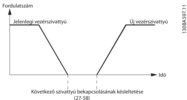
Ábra 3.111 Következő szivattyú üzemeltetésének késleltetése
